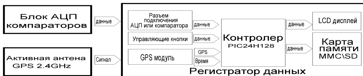
Рис. 1. Блок-схема регистратора данных
